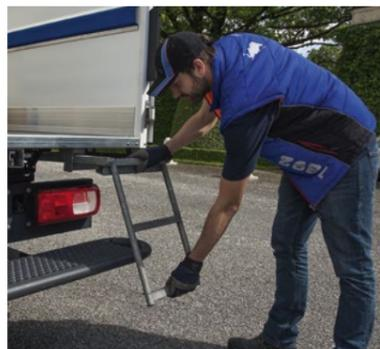
**Ausziehbare Aufstiegsleiter\*** aus verzinktem Stahl am Heck.
