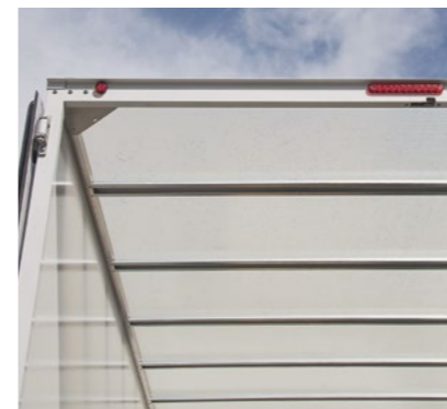
Transluzentes Lichtdach für einen hellen Innenraum – Standard bei der Configuration.
