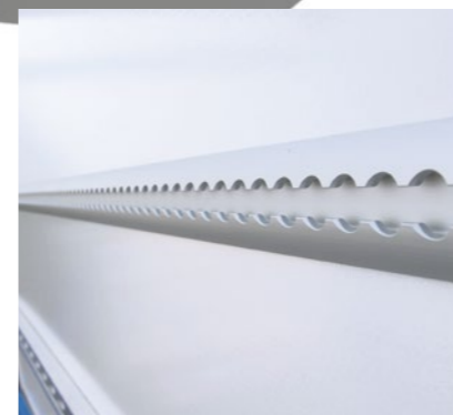
Airline-Schiene* an der Seitenwand für Studs und waagerechte Ladungssicherungsbalken (Höhe individuell festgelegt).
