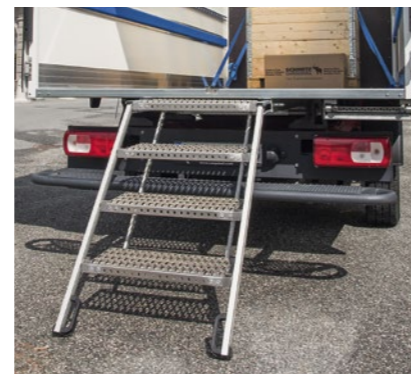
Treppe mit Klapptritt* , wahlweise mit drei oder vier Stufen, für den bequemen Zugang zur Fracht.
