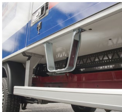
Einstiegsbügel* unter der Seitentür, Kotflügel* und Seitenanfahrtschutz* – die notwendigen Montagepunkte sind auf der Unterseite des Aufbaus schon ab Werk integriert.
