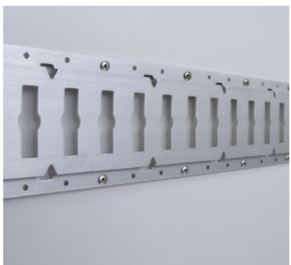
Durchgehende Kombi-Ankerschiene* in 900 mm Höhe für Zurrgurte und Ladungssicherungsbalken – Alternative zur Stäbchen-Zurrleiste.
