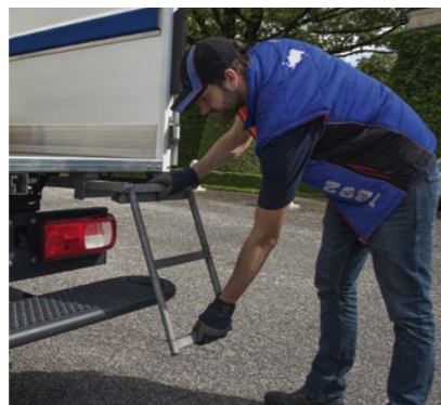
Ausziehbare Aufstiegsleiter* aus verzinktem Stahl am Heck.
