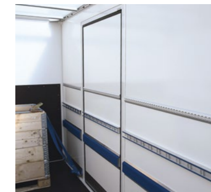
Seitentür* – mit durchgehender Ladungssicherung – ist innen exakt bündig mit Seitenwand. Das verhindert Ladungsschäden beim Durchschieben.
